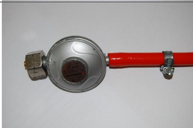
6. Ziehen Sie den Schlauch vom Stutzen des Druckminderers aus.
