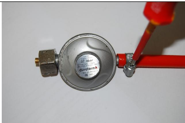
5. Verschieben Sie die Metallbinde unten dem Stutzen des Druckminderers.
